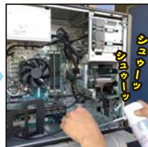
気を取り直して、エアダスターで丁寧に埃を飛ばしていきます。
